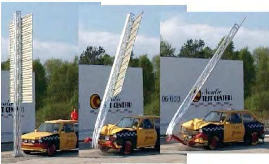
Essas sequências nos permitem verificar o comportamento do nossos suportes fusíveis como um sistema de segurança passiva 100 NE Tipo 2 sem absorção de energia.
