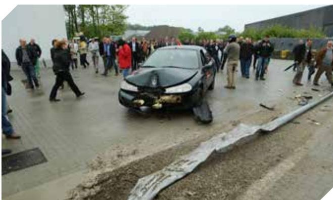
Las columnas multifuncionales de seguridad pasiva ZIPpole están diseñadas para salvaguardar esas vidas. Ante un impacto el poste cónico modifica instantáneamente la geometría cerrada de su sección y se transforma gradualmente en una estructura con mínima rigidez.
